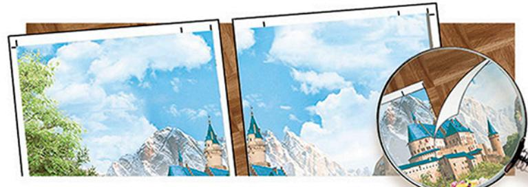
Острым макетным ножом по центрустыка извилистой или прямой линией прорежьте сразу два полотна. Удалите обрезанные полоски с обоих полотен.
